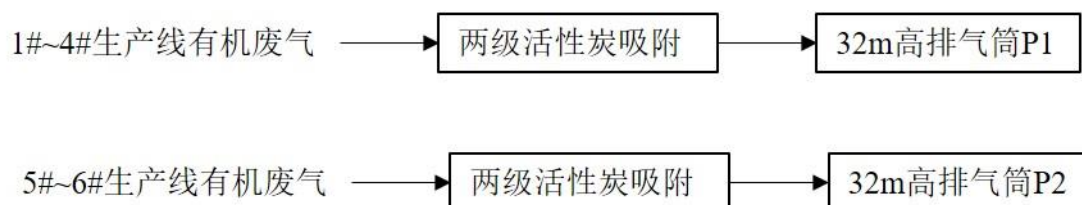
图 3-3 项目废气处理措施工艺流程图
